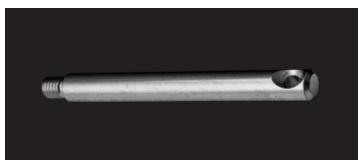
Der besonders starke Langdübel mit einem Anzugsweg von ca 4,5mm kann zum Beispiel für die Verbindung zwischen Massivholz und Spanplatte oder bei einer Riegelbauweise eingesetzt werden.
